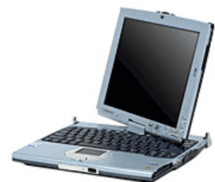
Acer TravelMate100 tablet PC , cuando cambia de modo portátil a modo tablet .
